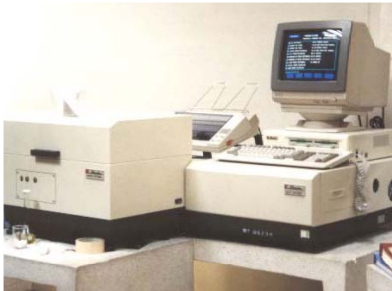
เครื่อง UV-VIS-NIR Spectrophotometer ใช้ทดสอบค่าการตอบสนองของคลื่นแม่เหล็กไฟฟ้า
